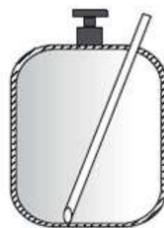
Схема расположения трубки в баллоне
