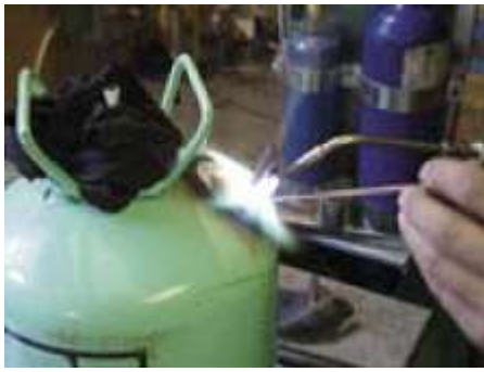
Перед пайкой место соединения штатного вентиля с баллоном обмотать мокрой тканью для отвода тепла
