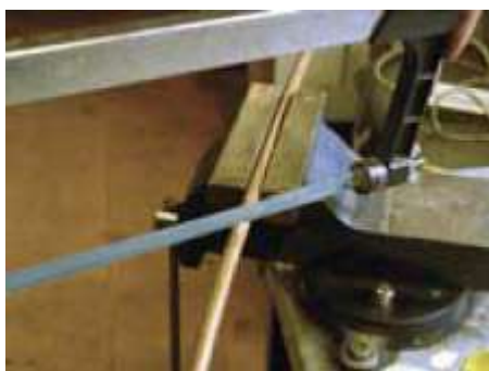
Отпиливаем кусок трубки нужной длины согласно схемы справа.
