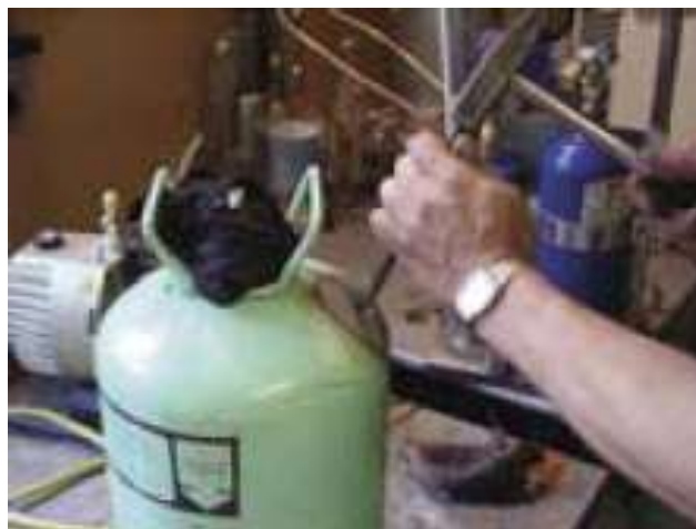
Только керном. Сверлить нельзя, иначе попадет стружка
